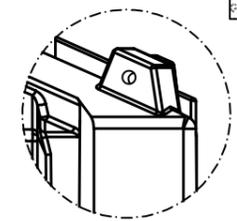
Kranösen für den Transport sind in jedem Tank integriert
