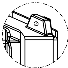
Kranösen für den Transport sind in jedem Tank integriert
