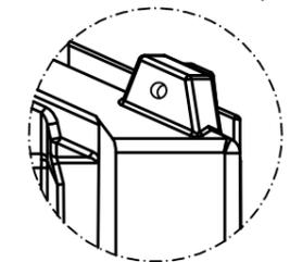
Kranösen für den Transport sind in jedem Tank integriert
