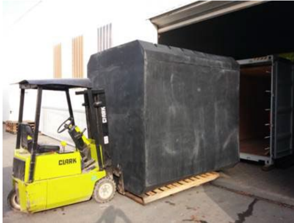
Einbau des Biomoduls in einen Seecontainer
