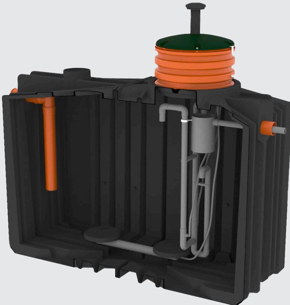
Die ClearFox® QuickONE+ ist eine biologische Kleinkläranlage, die mit dem SBR-Verfahren arbeitet. Sie ist vollständig in einem Kunststoffbehälter vormontiert und sofort einsatzbereit. Trotz des geringen Stromverbrauchs erreicht sie eine herausragende Ablaufqualität.
