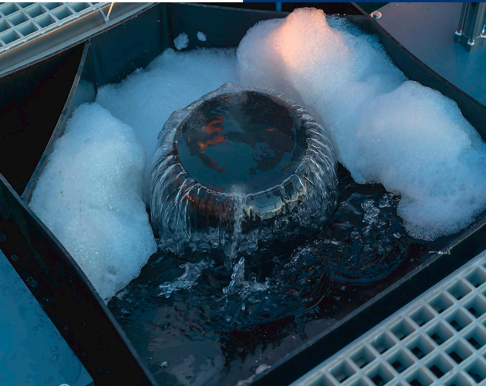
Die ClearFox® DAF Druckentspannungsflotation ist ein physikalisch-chemisches Verfahren zur Abtrennung einer Vielzahl von Schadstoffen aus dem Abwasser. Der eigens entwickelte Flotationsreaktor ermöglicht eine effiziente Abtrennung von Schadstoffen aus dem Abwasser bei geringeren Betriebskosten als bei herkömmlichen Druckentspannungsflotationen.
