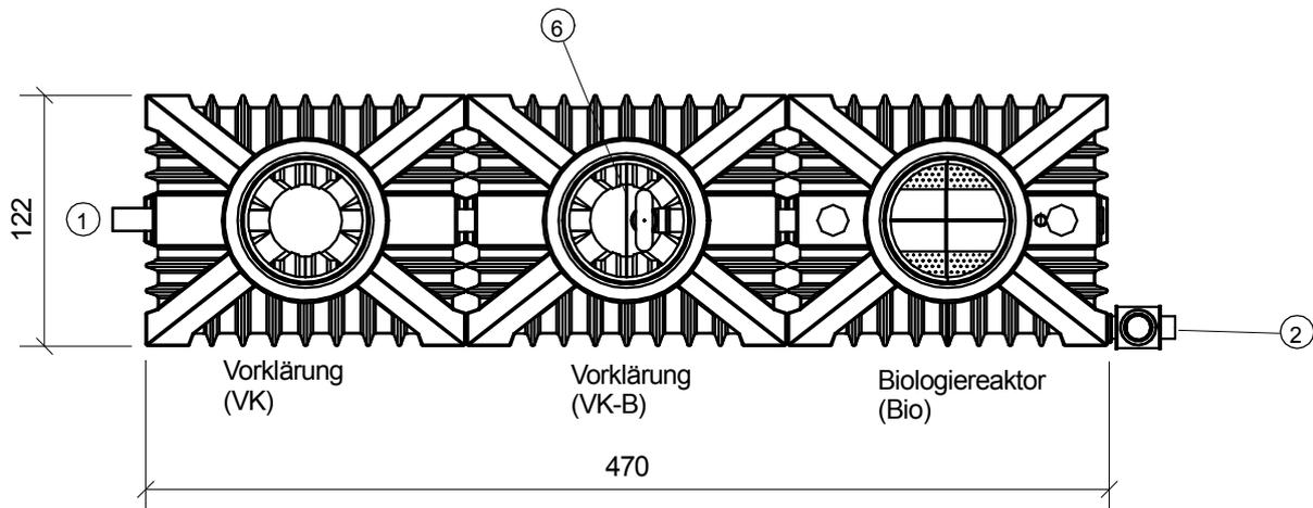
1. Zulauf DN100 ( $\text{\O}a=110\text{mm}$ ) (Mat. KG/PE)
